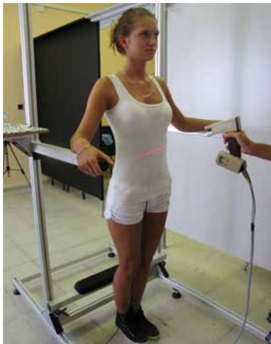
Odobratie memých podkladov 3D skenerom pomocou laserového lúča
