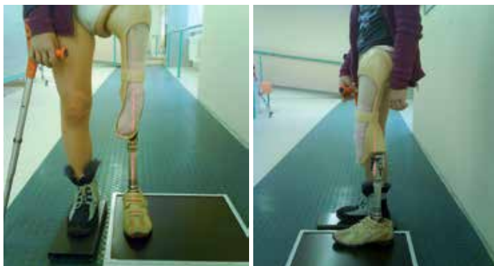
Obrázky 59: Zviditeľnenie záťažových línií laserovým lúčom
